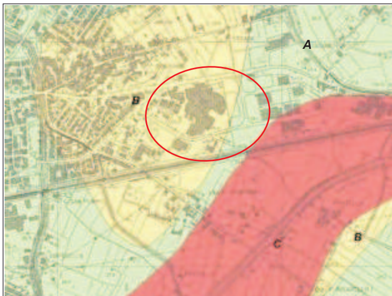
Carta della Fattibilità geologica Estratto Tav. 2.5 Classe A: Condizionamento basso Classe B: Condizionamento medio
